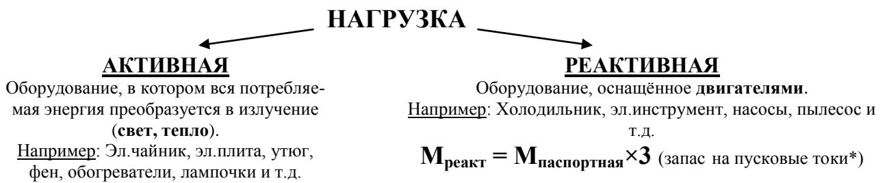
\* Пусковые токи могут достигать до 15 раз. Например, у погружного насоса, который поднимает воду со 100 метров глубины пусковой ток составит 10 раз. Что т.е. и начальный паспортный потребляемый токушки будет в 3 раза
