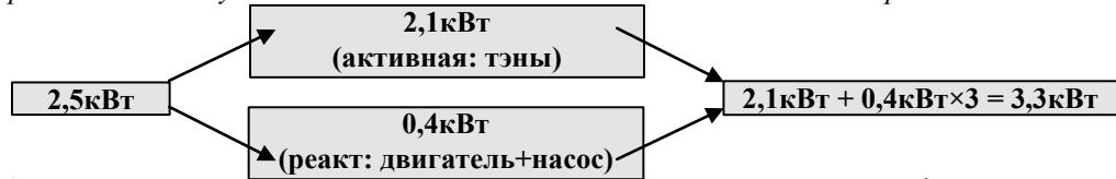
Приборов со смешанной нагрузкой в квартире довольно много, например, фен, но у него тэны составляют порядка  $1,6\text{kVt}$ , а «пропеллер», который дует воздух порядка  $40\text{Вт}$ , поэтому нет смысла производить раздельные подсчёты и фен относим к активной нагрузке и т.п. Два прибора, у которых может кардинально поменяться мощность это стиральная машина и посудомоечная (подсчёт аналогичный!). Запомните - их мощность считается  $3,3\text{kVt}$ .
