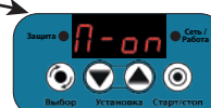
Временный режим функции "Полив" включен, функция полив выключится через 3 часа, через 1 секунду прибор перейдет в режим "ПАУ"
