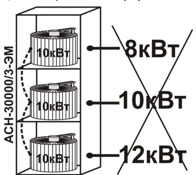
Необходимо помнить, что трёхфазный стабилизатор состоит из трёх однофазных стабилизаторов одинаковой мощности (т.е. если у вас трёхфазный стабилизатор на 30кВт, то внутри у вас три катушки по 10 кВт), соединённых общей цепью.
