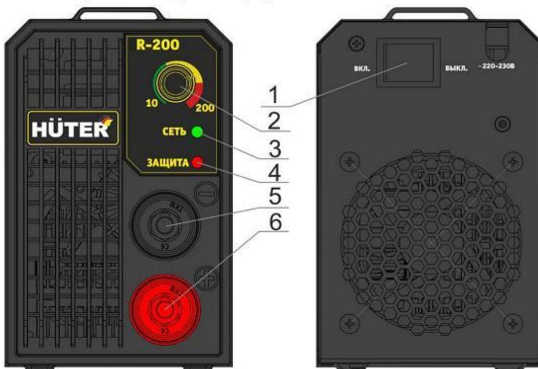
Принцип работы сварочного аппарата заключается в преобразовании переменного напряжения сети частотой 50Гц в постоянное напряжение величиной в 400В, которое преобразуется в высокочастотное модулированное напряжение и выпрямляется. Для регулирования сварочного тока используется широтно-импульсная модуляция высокочастотного напряжения.
