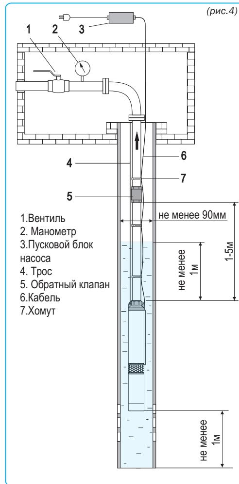
Он препятствует вытеканию воды из системы в скважину после остановки насоса и защищает насос от давления столба воды.
